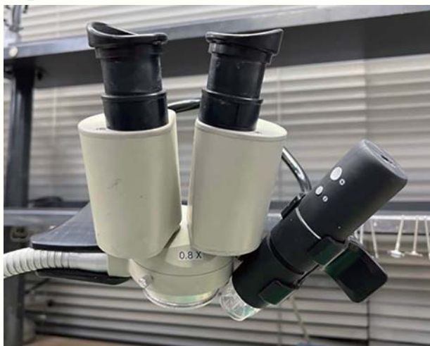
fig.1 デジタルマイクロスコープは小型なので簡単に取り付ける事ができる
