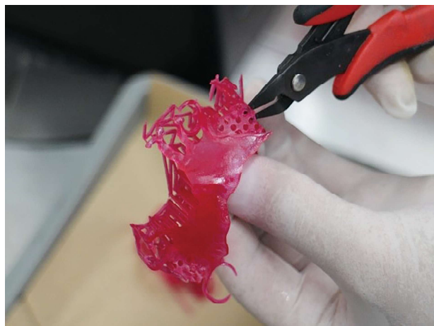
Fig.12 重合完了後にサポートピンを切り離す。
