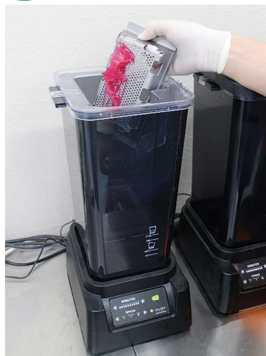
Fig.9 専用機器で洗浄を行う。
