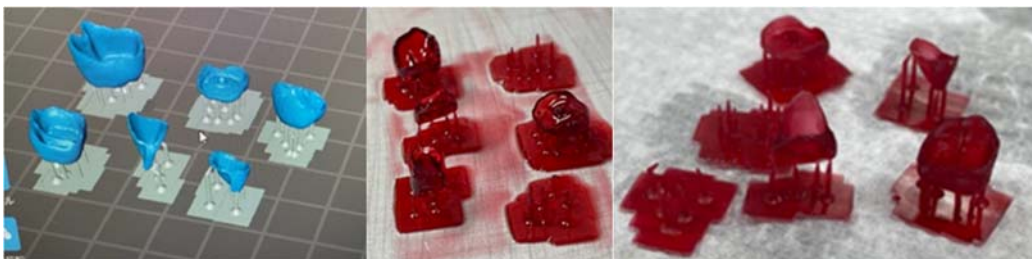
図2. 設計と実際にプリントアウトされたクラウンのパターン
