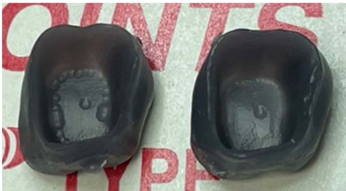
図 5. 右側が今回導入したソフトによるデザイン、内面の精度が違う
