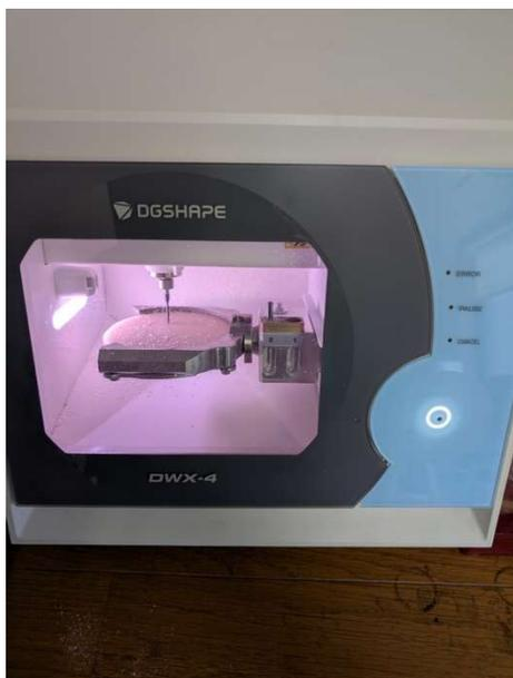
図 16. 追加した CAM 専用アダプター
